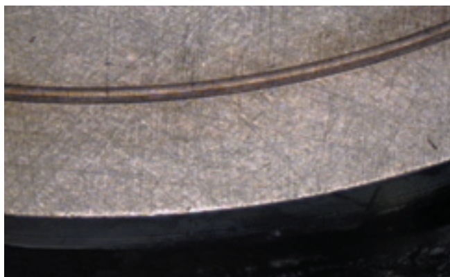
Gola dopo 24 ore di rodaggio Run-in groove after 24 hours
