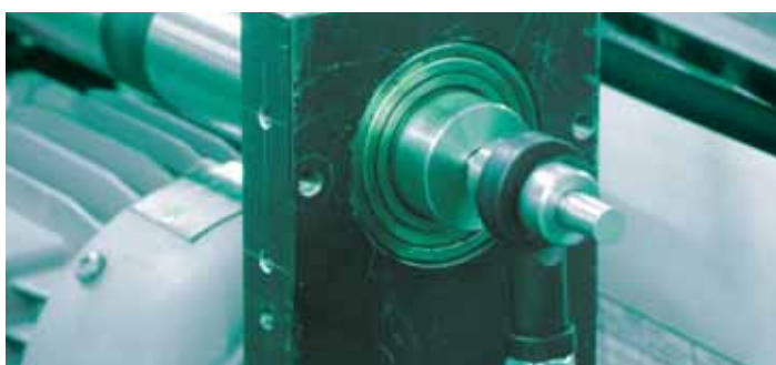
Foto 1.8: Verifica della massima velocità ammissibile per una testa a snodo igubal®, movimento rotatorio
