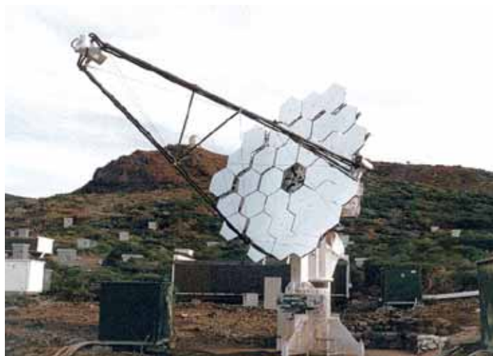
Foto 50.1: Osservatorio di La Palma (Spagna): supporti igubal® nel dispositivo che regola l'inclinazione degli specchi del telescopio.
