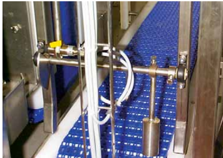
Foto 53.2: Dettaglio di montaggio dei supporti igubal®
