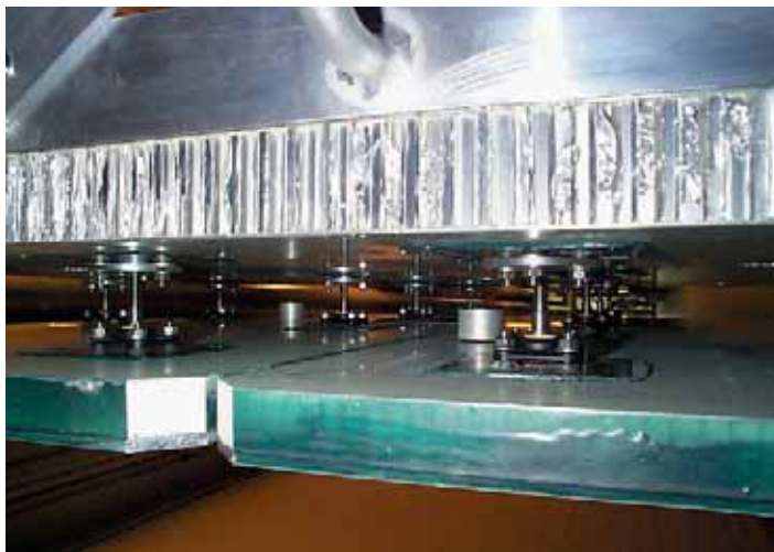
Foto 54.2: Supporto igubal® nel dispositivo di inclinazione degli specchi
