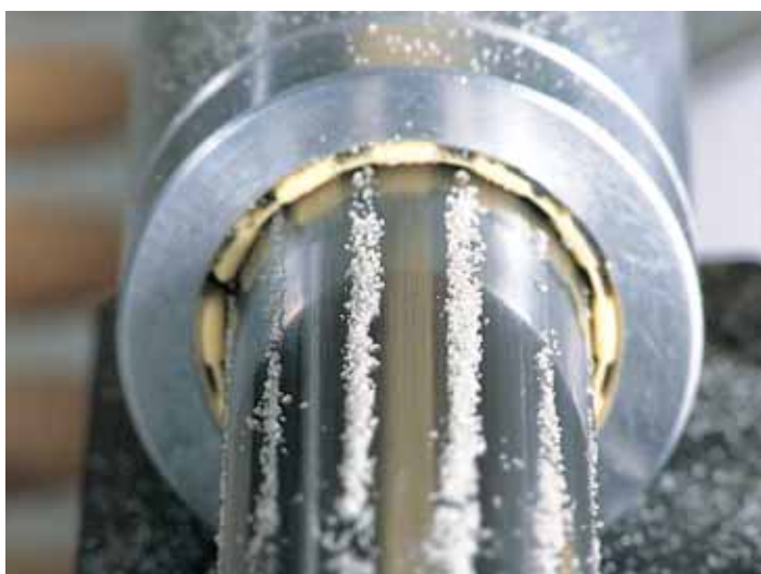
Foto 1.15: Eccellente resistenza all'abrasione: cuscinetto a contatto permanente con sabbia
