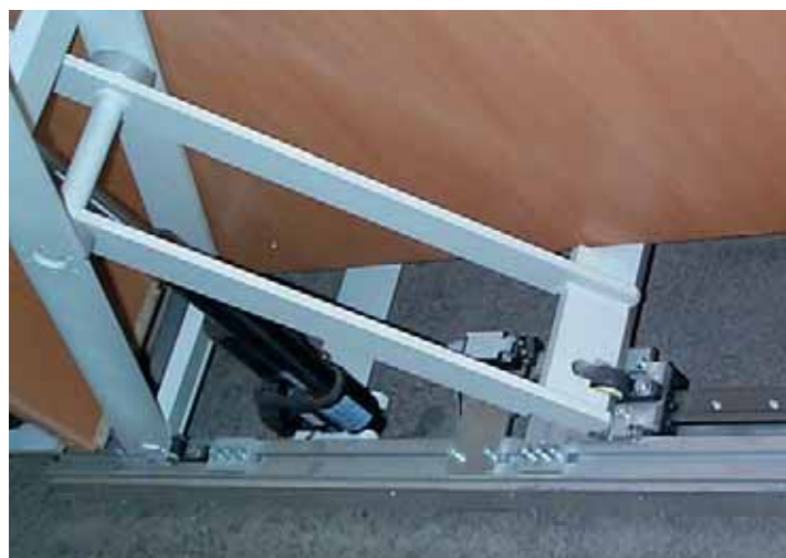
Foto 53.5: Supporto snodato igubal® ancorato su un pattino DryLin® T nel meccanismo di sollevamento dello schermo TV
