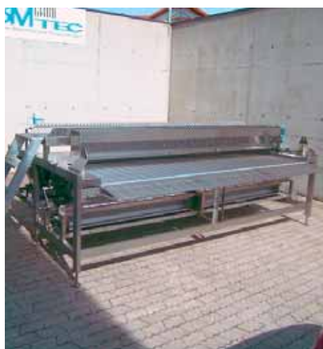
Foto 54.5: Impianto per la glassatura di prodotti da forno (dettaglio nella foto a lato)
