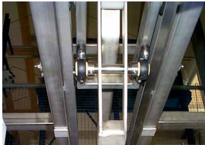
Foto 53.3: Dettaglio di montaggio dei supporti igubal®
