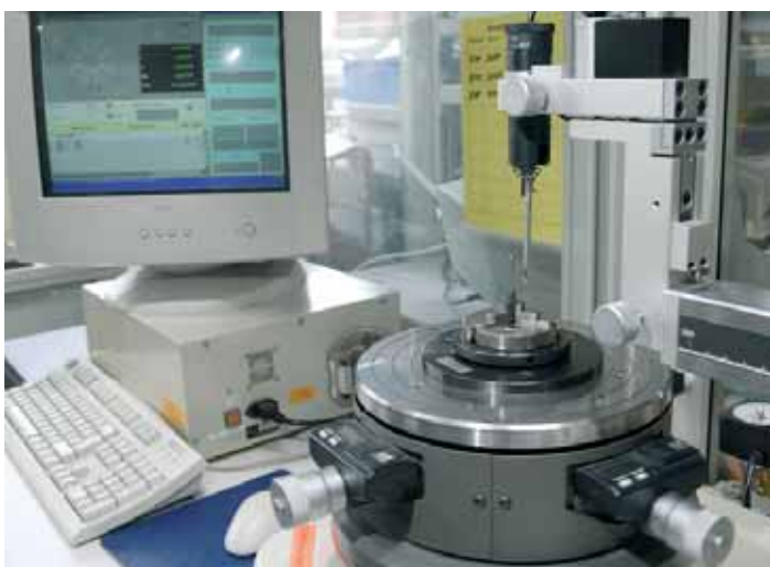
Foto 1.19: Misurazione del diametro interno di un cuscinetto, dopo piantaggio in sede
