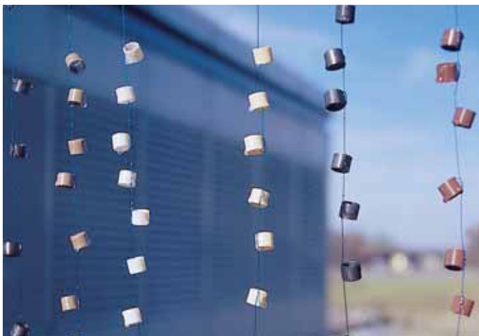
Foto 1.18: Cuscinetti iglidur® durante la prova di esposizione ai raggi UV
