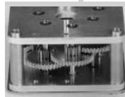
Foto 4.2: Gli ingranaggi e gli organi di trasmissione richiedono cuscinetti esenti da manutenzione dalle caratteristiche universali.
