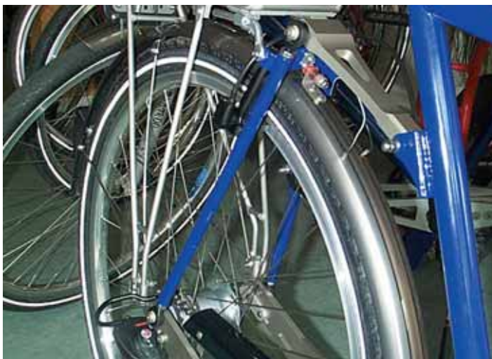
Foto 50.4: Teste a snodo igubal® sull'ammortizzatore posteriore di una bicicletta
