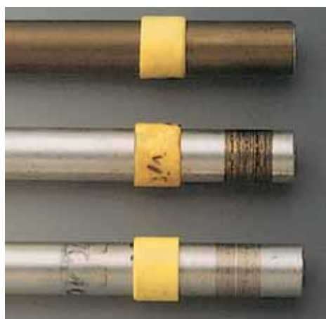
Foto 1.16: Prove di usura su alberi in alluminio con diversi trattamenti superficiali
