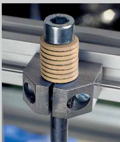
Foto 36.1: Prova di durata per molle a tazza Polysorb®
