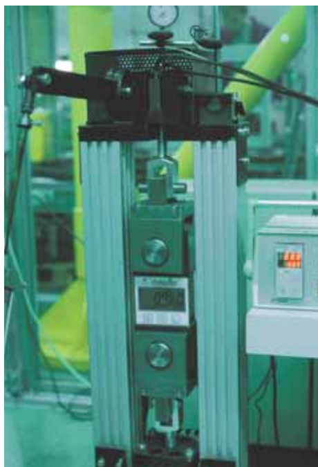
Foto 1.13: Banco prova per carichi fino a 150 MPa e temperature fino a 250°C
