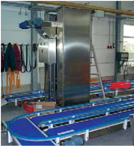
Foto 53.1: Supporto snodato igubal® in un impianto di convogliamento per il settore alimentare (vedi dettagli nelle foto a lato)
