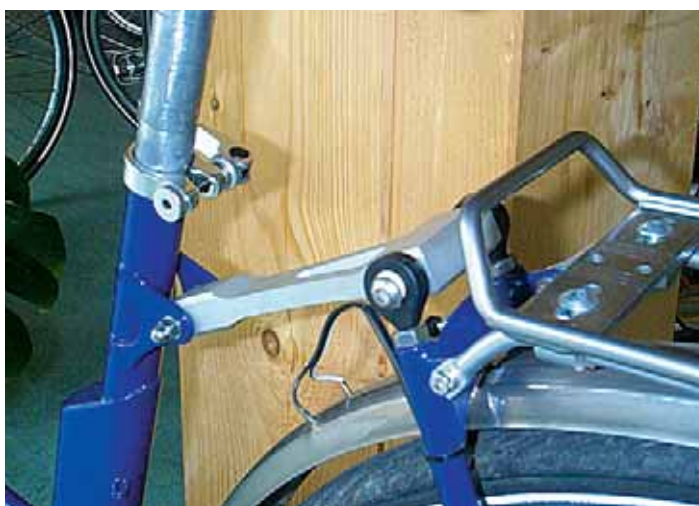
Foto 51.2: Teste a snodo igubal® sull'ammortizzatore posteriore di una bicicletta
