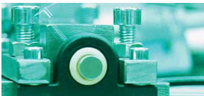
Foto 1.7: Prove di laboratorio per valutare il coefficiente di attrito e l'abrasione di un supporto snodato igubal®
