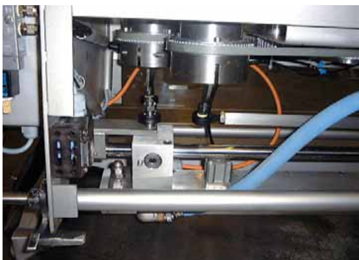
Foto 51.1: Snodi igubal® in un'attrezzatura per la decorazione di cioccolatini
