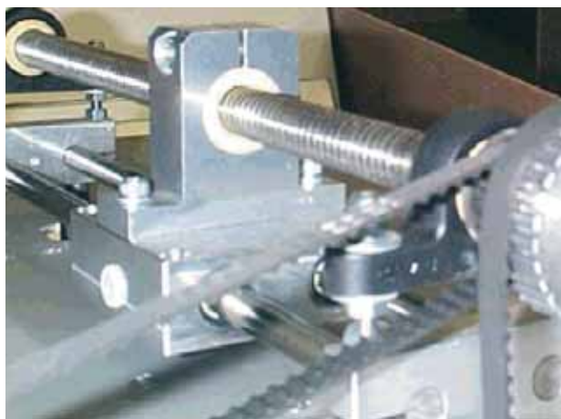
Foto 66.1: Esempio di impiego di madreviti in combinazione con i cuscinetti a strisciamento DryLin®
