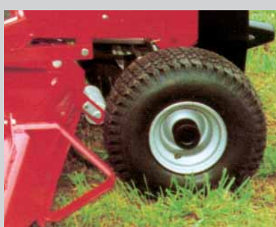
Foto 4.4: Cuscinetti iglidur® M250 sui mozzi delle ruote per tosaerba; insensibilità alla sporcizia, resistenza alla corrosione ed eccellenti capacità ammortizzanti.
