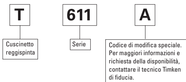
Fig. 41. Codifica dei cuscinetti reggispinta standard.
