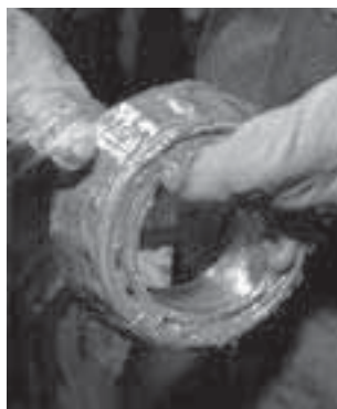
Fig. 23. Il riempimento con grasso può essere facilmente effettuato anche a mano.
