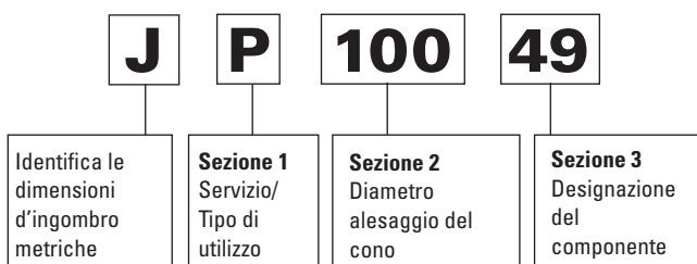
Fig. 28. Sistema di numerazione componenti della serie J-line.
